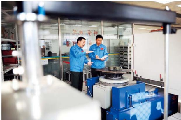
技术人员对北斗车载用户终端的天线进行抗振动试验 新华社图
