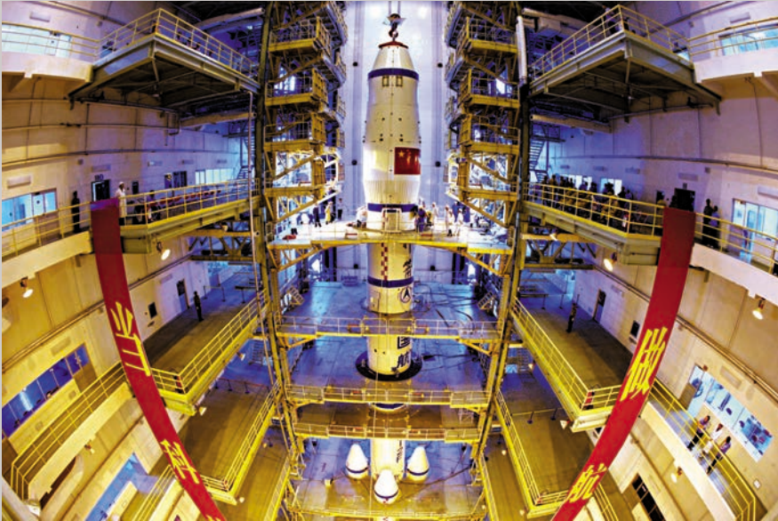
ຍານອາວະກາດເຊີນໂຈວເປີ 7 ຕໍ່ເຂົ້າກັນກັບຈະຫຼວດອິນສິ່ງ F ຊາງເຈີນເປີ 2 ໃນໂຮງຈັກໂຮງງານປະກອຍຊີ້ກົງ 神舟七号飞船与长征二号 F 运载火箭在垂直装配厂房进行对接 新华社图
