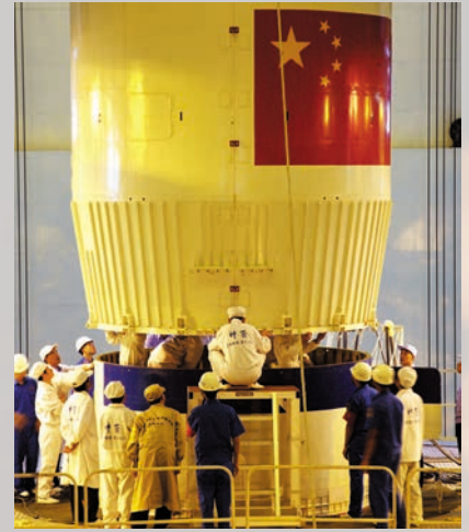
ຍານອາວະກາດເຊີນໂຈວເປີ 7 ຕໍ່ເຂົ້າກັນກັບຈະຫຼວດອິນສິ່ງ F ຊາງເຈີນເປີ 2 ໃນໂຮງຈັກໂຮງງານປະກອຍຊີ້ກົງ 神舟七号飞船与长征二号 F 运载火箭在垂直装配厂房进行对接 新华社图
